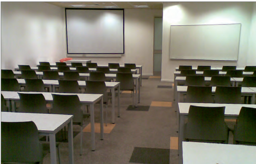
Slika 31. Fotografija prikazuje predavaonicu koja je projektirana tako da je ulaz na istoj razini s podom te je dovoljan razmak između stolova za nesmetan prolaz.
