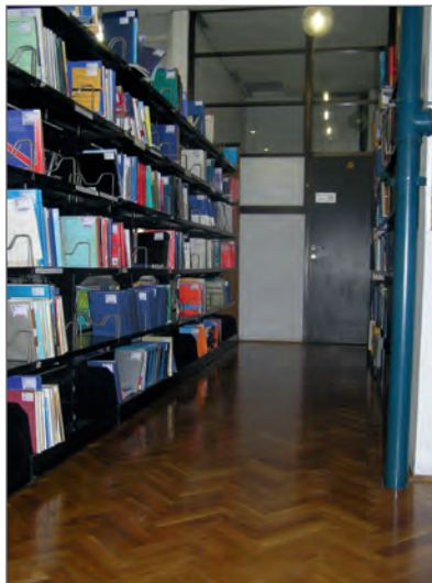
Slika 37. Primjer loše i dobre prakse. Fotografija prikazuje prostor između policama bez prepreka širine veće od 150 cm (primjer dobre prakse). Knjige na policama su izvan aktivnog dosega osoba koje se kreću uz pomoć invalidskih kolica (primjer loše prakse).
